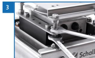
3. Die Höhe des Sensors ist mit den vier M8x50 Sechskantschrauben einzustellen.
