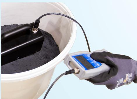
Bei Bedarf: Laborauftrag Art. Nr. 11217 zur Kennlinienerstellung eines Materials für das humimeter SG1
