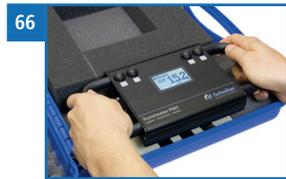
» Der angezeigte Wassergehalt muss zwischen 14,5 und 15,5 liegen. (Der Feuchtwert wird schwarz angezeigt.) (Bild 67)
