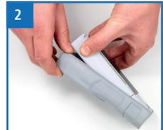
2. Nehmen Sie das Gerät in eine Hand und drücken Sie mit dem Daumen auf die gravierte Stelle des Batteriedeckels (1). Ziehen Sie den Batteriedeckel nun nach unten vom Gerät (2) (Bild 3).
