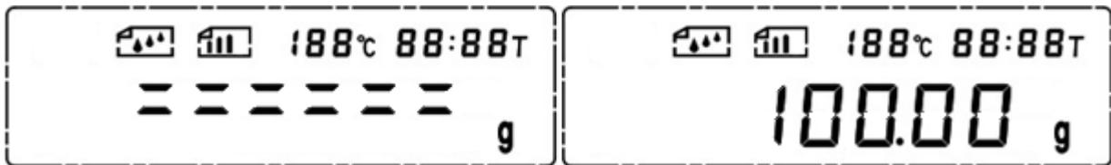
Wenn das Display nun von „=====“ wieder zu „100,00 g“ wechselt, ist das Gewicht von der Wiegefläche zu nehmen. Danach zeigt das Display wieder „=====“ an und wechselt selbstständig zu „0,00 g“.
