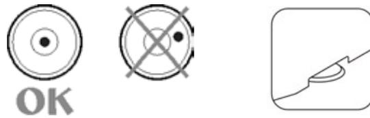
Um exakte, wiederholbare Messergebnisse zu erhalten, ist es wichtig die Waage mithilfe der Libelle und den beiden Einstellrädern exakt auszurichten. Verdrehen Sie die Einstellräder so, dass sich die Luftblase in der Libelle genau im Mittelpunkt des Kreises befindet.
