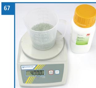
7. Nun befüllen Sie die Messkammer des Gerätes langsam und gleichmäßig mit den 400 g Glasperlen (Bild 68).
