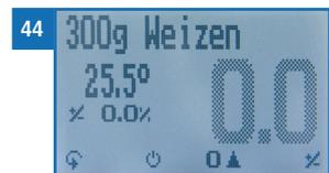
2. Drücken Sie zweimal
