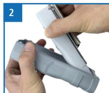
2. Nehmen Sie das Gerät in eine Hand und drücken Sie mit dem Daumen auf die gravierte Stelle des Batteriedeckels (1). Ziehen Sie den Batteriedeckel nun nach unten vom Gerät (2) (Bild 3).
