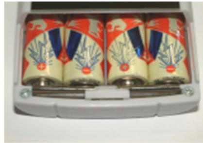
Erscheint das Batteriesymbol im Messfenster bzw. wird im Statusfenster kritischer Ladezustand angezeigt, sind **UNVERZÜGLICH** die Batterien zu wechseln. Wird das humimeter Gerät für längere Zeit nicht gebraucht, sind die Batterien aus dem Gerät zu entfernen. Für ggf. daraus resultierende Schäden gibt es keinen Garantieanspruch.
